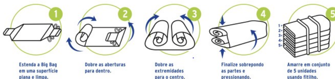
FIGURA 1: Procedimento recomendado para acondicionamento de contentores
